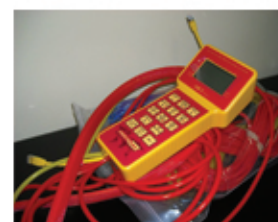
Blower door test mjeri propusnost vazduha kroz ometač objekta.
